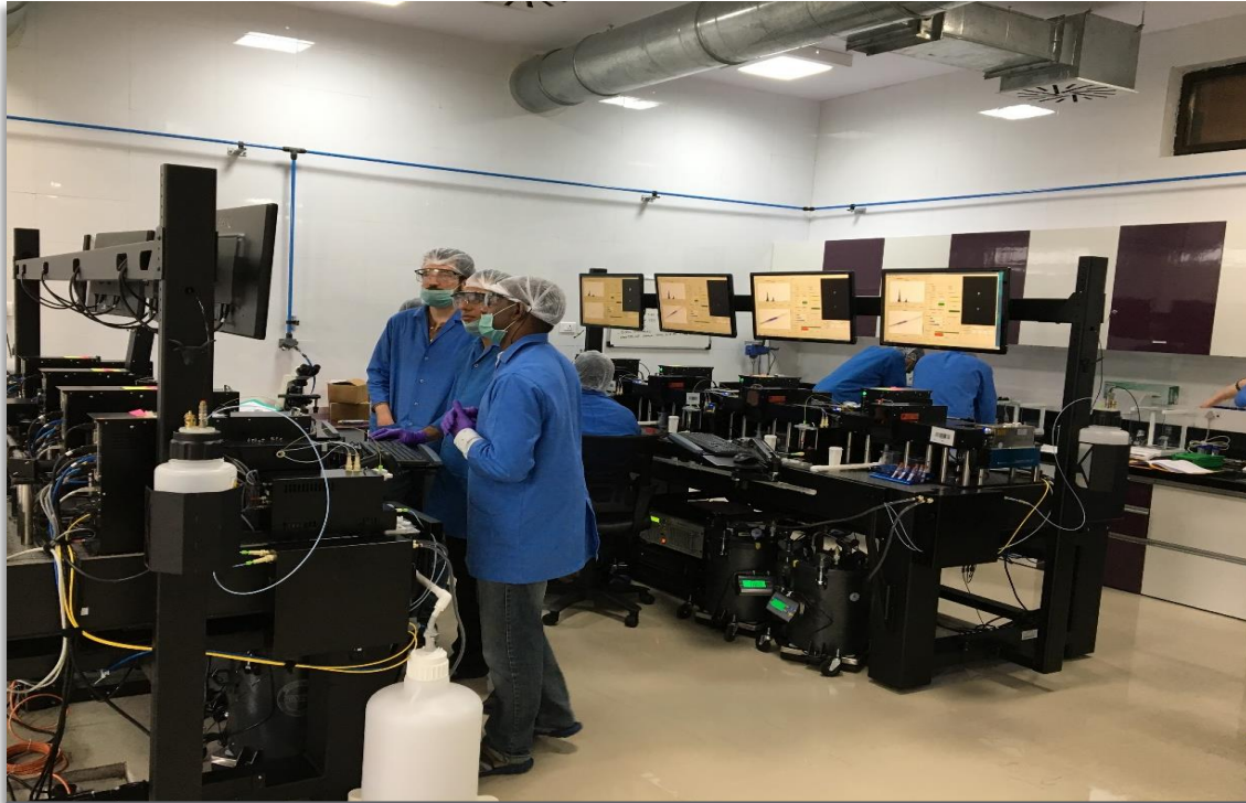
Машины по производству семени со смещенным соотношением полов IntelliGen 1 поколения
